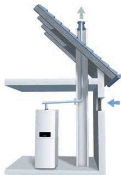
Varijanta za podno postavljanje neovisno o zraku iz prostorije s uvučenom cijevi odvoda dimnih plinova u dimnjaku (neprikladno za uvlačenje zraka)
